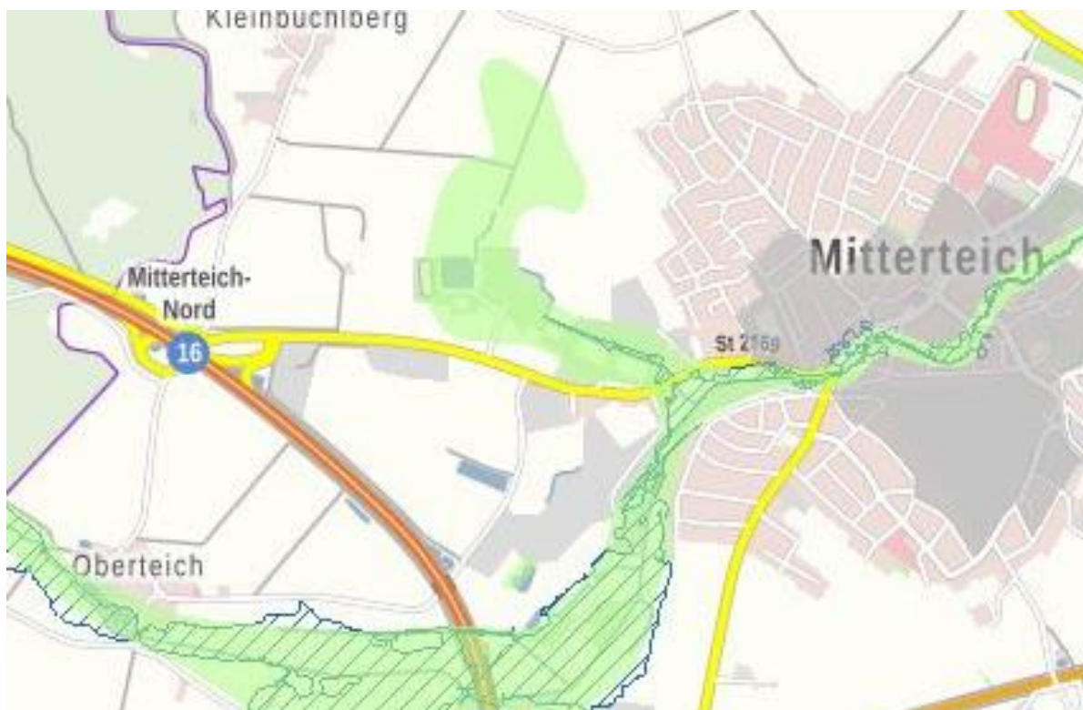
Abbildung 4: Wassersensible Bereiche (Hellgrün), vorläufig gesicherte Überschwemmungsgebiete (Blau schraffiert im Umfeld der Planung (Rot) [Bayernatlas, 2022]
